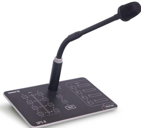
Pomoću SPS 8 i BlueLine Digital sustava moguće je raditi govorne objave do u 32 različite zone – prostora. Talk tipka podesiva kao prekidač ili push-to-talk način rada. AUX RCA stereo konekcija za spajanje izvora pozadinske glazbe. Napajanje PoE ili 12 V DC putem euroblock konektora. Alarmni ulaz za aktiviranje programiranih radnji, npr. aktiviranje digitalnih izlaza na jednom od BlueLine uređaja iz sustava ili puštanje snimljene poruke sa BLS SD modela.
